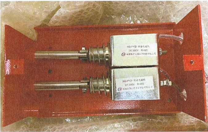
图 4-1 排油电磁型驱动器
